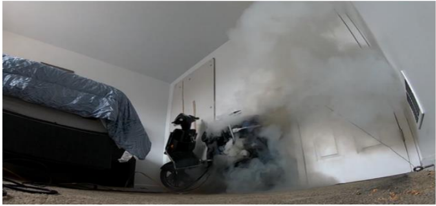
E-scooter'dan çıkan duman, lityum iyon pilin termal kaçak yaşadığının göstergesidir.
